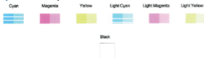
Rysunek 9-2 Przykładowe bloki kolorów z defektami
