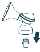
Wyciągnij zawór ze złączenia
