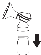
Odkręć butelkę od złączenia
