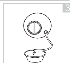
Po spuszczeniu wody odłóż wąż na miejsce
