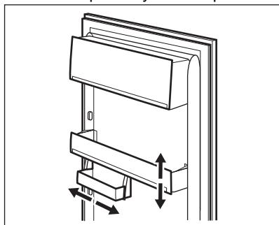
Ten model jest wyposażony w regulowany pojemnik, który można przesuwać na bok.
