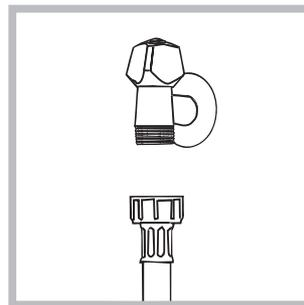
1. A vízbevezető cső csatlakoztatásához csavarozza fel a csövet egy 3/4"-os külső menettel rendelkező hidegvíz-csapra (lásd ábra). A csatlakoztatás előtt eressze meg a csapot, és folyassa a
