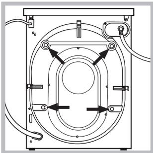
3. Csavarozza ki a készülék hátsó részén található, a szállításhoz szükséges védőcsavart, és távolítsa el a gumi-bakot a távtartójával együtt (lásd ábra).
