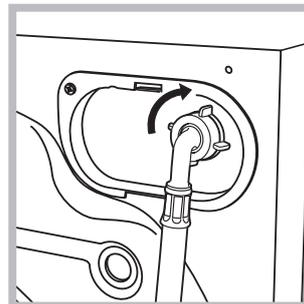
2. A vízbevezető cső csatlakoztatásához csavarozza a csövet a mosógép hátoldalán jobbra fent található vízbemeneti csomagra (lásd ábra).
