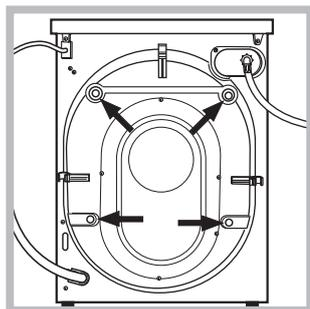
3. Отстранете те защитни винта за предпазване при превоза и гумираната опаковка със съответния раздалечител, намиращи се в задната част (вижте фигурата).
