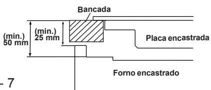
Se o forno for instalado sobre uma placa de fogão, a distância entre a bancada e o painel superior do forno deve ser de, no mínimo, 50 mm e a distância entre a bancada e o cimo do painel de controle deve ser de, no mínimo, 25 mm.
