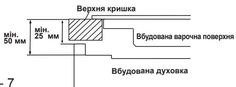
Якщо духовка встановлюється під варочною поверхнею, відстань від робочою поверхнею та духовкою має бути не менше ніж 50 мм, а між робочою поверхнею та верхом панелі керування — не менше ніж 25 мм.
