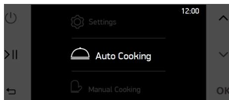
No menu de cozedura automática, o nome e o peso da receita são selecionados pelo utilizador final. Também o tempo do fim da cozedura pode ser alterado pelo utilizador final. Para alterar quaisquer especificações, navegue com os botões CIMA e BAIXO e selecione as especificações com o botão OK. Depois de tocar, a especificação selecionada irá piscar. Enquanto estiver a piscar, os botões CIMA e BAIXO são usados para alterar o valor da especificação. Pode terminar a seleção tocando no botão OK.
