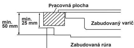
Ak rúru inštalujete pod varič, vzdialenosť medzi pracovným povrchom a horným panelom rúry musí byť minimálne 50 mm a vzdialenosť medzi pracovným povrhom a vrchom ovládacieho panela musí byť minimálne 25 mm.
