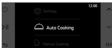
I autotillagningsmenyn väljs kategori, namn och vikt för receptet av slutanvändaren. Även tillagningens sluttid kan ändras av slutanvändaren. För att ändra någon specifikation, navigera med knapparna UPP och NER och välj specifikation med knappen OK. Efter att du pekat, blinkar vald specifikation. Under blinkning, används knapparna UPP och NER för att ändra värdet för specifikationen. Du kan slutföra valet genom att peka på knappen OK.
