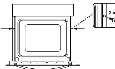
Sätt in ugnen i skåpet genom att skjuta den framåt. Öppna ugnslackan och sätt i de 2 skruvarna i hålen på ugnens ram. När produktramen vidrör träytan på skåpet, dra åt skruvarna.
