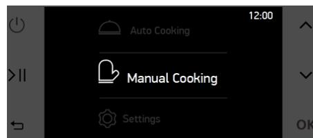
W menu gotowania ręcznego można ustawić funkcje gotowania, temperaturę, funkcję podgrzewania przyspieszonego (Boost), czas przygotowania potrawy i czas zakończenia przygotowania potrawy. Żeby zmienić dowolne ustawienie, przyciskami UP & DOWN ustaw żądaną opcję i wybierz ją, naciśkając przycisk OK. Po naciśnięciu wybrane ustawienie zacznie pulsować. Jeśli dane ustawienie pulsuje, przyciskami UP & DOWN zmień wartość ustawienia. Możesz zatwierdzić wybór, naciśkając przycisk OK.
