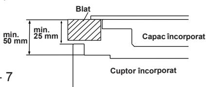
Dacă instalați cuptorul sub o poliță, distanța între blatul de lucru și panoul de sus al cuptorului trebuie să fie de minimum 50 de milimetri, iar distanța între blatul de lucru și partea superioară a panoului de control trebuie să fie de minimum 25 de milimetri.
