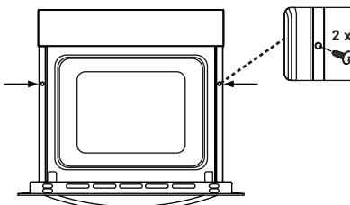
Insira o forno dentro do compartimento empurrando-o para a frente. Abra a porta do forno e insira 2 parafusos nos furos situados na armação do forno. Enquanto a armação do produto estiver tocar na superfície de madeira do compartimento, aperte os parafusos.
