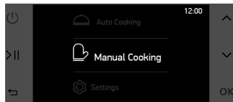
I den manuella tillagningsmenyn kan tillagningsfunktioner, temperatur, boostfunktion, tillagningstid och sluttid ställas in av slutanvändaren. För att ändra någon specifikation, navigera med knapparna UPP och NER och välj specifikation med knappen OK. Efter att du pekat, blinkar vald specifikation. Under blinkning, används knapparna UPP och NER för att ändra värdet för specifikationen. Du kan slutföra valet genom att peka på knappen OK.
