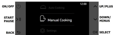
Unitatea de comandă monocromă este concepută de o astă manieră încât să determine amatorii să realizeze cu ușurință rețete profesionale, folosind funcțiile de preparare automată și încât să permită gospodinelor să realizeze propriile rețete cu funcții de preparare manuală combinate.
