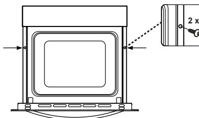
Introduceți cuptorul încorporat în dulap și împingeți-l în față. Deschideți ușa cuptorului și introduceți două șuruburi în găurile amplasate în rama cuptorului. Strângeți șuruburile, când rama produșului atinge suprafața de lemn a dulapului.
