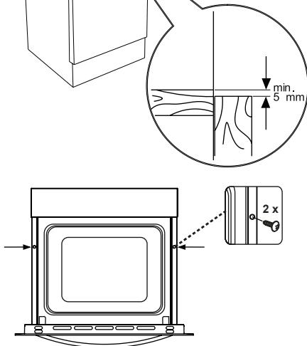
Vložte rúru do skrinky jej zasunutím smerom dopredu. Otvorte dvere rúry a vložte 2 skrutky do otvorov nachádzajúcich sa na ráme rúry. Zariadťte, aby sa rám produktu dotýkal dreveného povrchu skrinky, a utiahnite skrutky.
