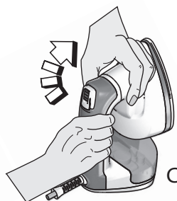
C Повернуть подошву по часовой стрелке, используя предназначенную для этого ручку
