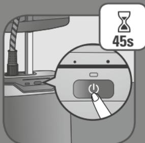
**SK** Zariadenie spustíte stlačením spínača ON/OFF. Stupeň pary bude blikať max. 45 sekúnd.
