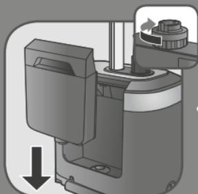
**HU** Csavarja vissza teljesen a víztartály fedelét, és illeszze vissza a víztartályt a készülékbe.
