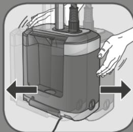
**SK** Lahkým trasením spotrebiča odstráňte hlavné čistočky.
