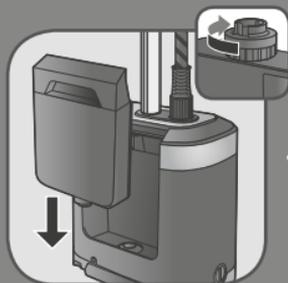
**SK** Pevne zaskrutkujte uzáver zásobníka a vložte zásobník späť na miesto.
