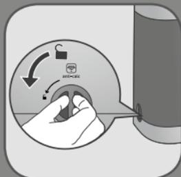
**HU** Helyezze a készüléket a mosdó fölé, és csavarja le a «Vízkötlénítő» kupakot, az óramutató járásával ellentétes irányba forgatva azt.
