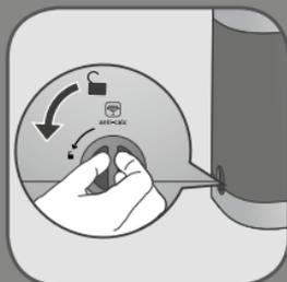
**LV** Novietojiet ierīci virs izlietnes un atskrūvējiet „Anti Calc” atkalķošanas vāciņu, pagriežot pretēji pulksteņrādītāja kustības virzienam.
