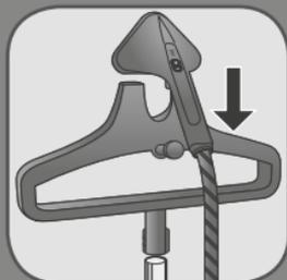
**LT** Atrakinkite pakabos užraktą ir iki galo užmaukite vertikaloje padėtyje ant strypo viršaus, tada ją įtvirtinkite.
