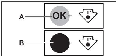
**i** Po vložení čerstvých potravin do spotřebiče nebo po opakovaném otevření dveří na delší dobu je normální, když se přestane zobrazovat hlášení OK. Vyčkejte alespoň 12 hodin, než provedete nové nastavení ovladače teploty.
