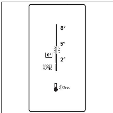
Dacă setați temperatura la 5°C sau mai mult, temperatura din interiorul compartimentului LongFresh 0° va fi de peste 3°C.
