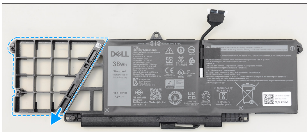
Rysunek 27. Wymontowywanie baterii 2-ogniowej
