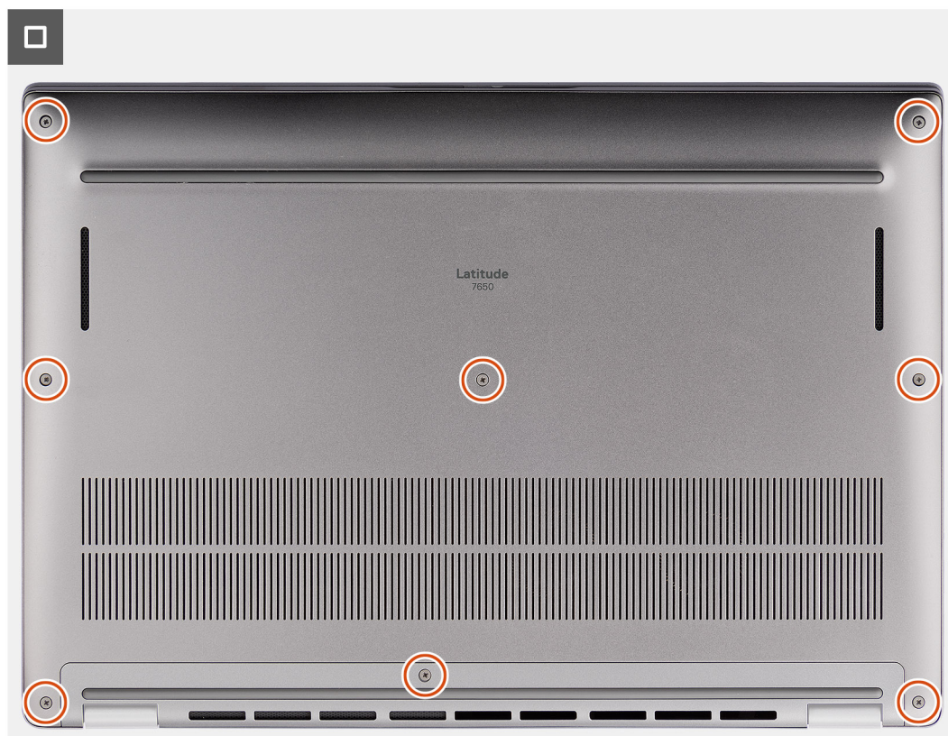
Rysunek 13. Instalowanie pokrywy dolnej
