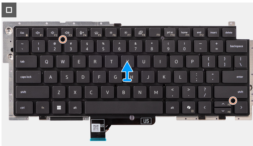
Rysunek 65. Wymontowywanie klawiatury
