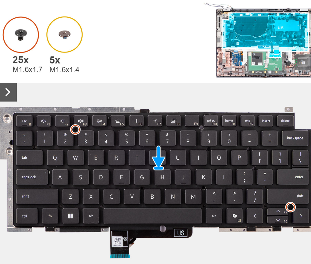
Rysunek 66. Instalowanie klawiatury
