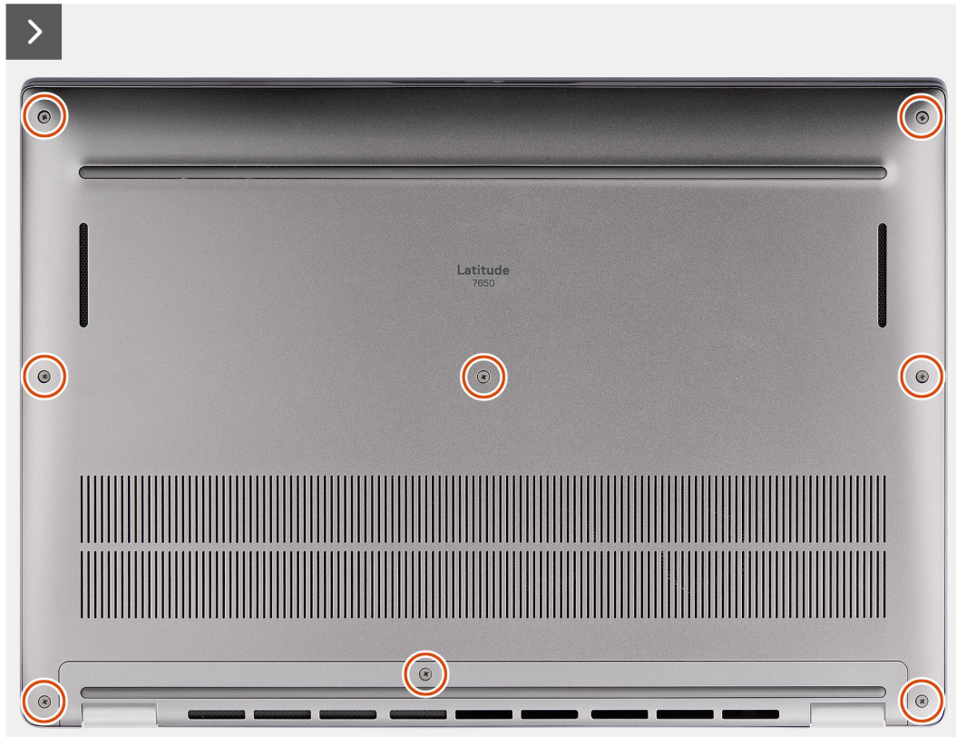
Rysunek 11. Wymontowywanie pokrywy dolnej
