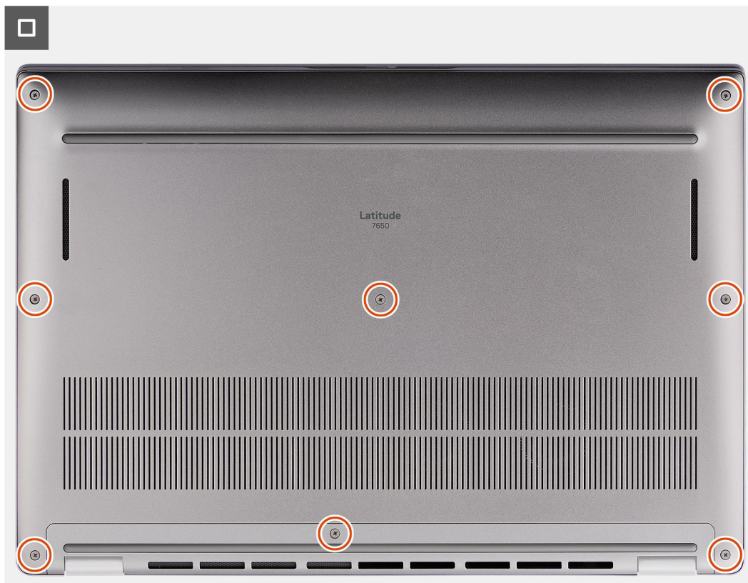
Rysunek 14. Instalowanie pokrywy dolnej
