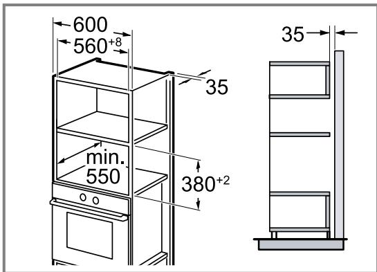
Urządzenie należy zamontować na takiej wysokości, aby możliwe było swobodne wyjmowanie wyposażenia. Wyregulować nóżki.
