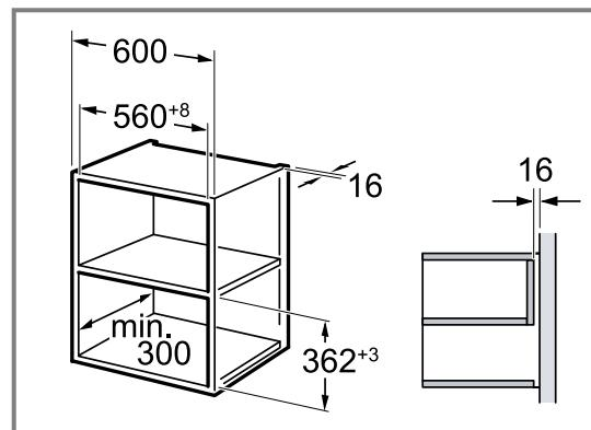
Urządzenie należy zamontować na takiej wysokości, aby możliwe było swobodne wyjmowanie wyposażenia.
