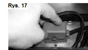
Rys. 17 Założyć i zapiąć skrzynki połączeń
