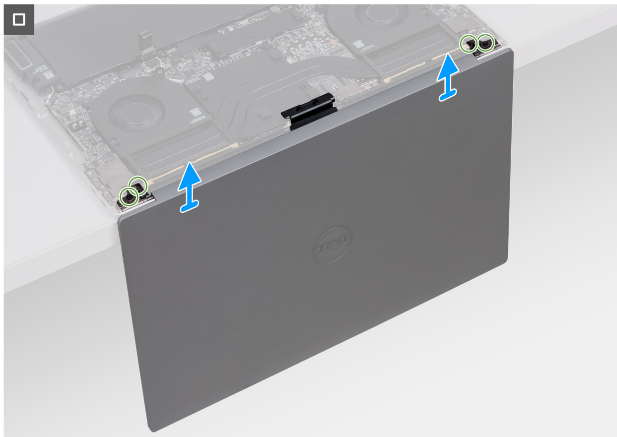
Rysunek 39. Wymontowywanie zestawu wyświetlacza
