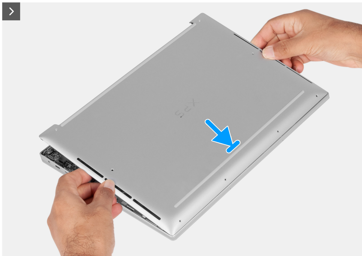
Rysunek 16. Instalowanie pokrywy dolnej
