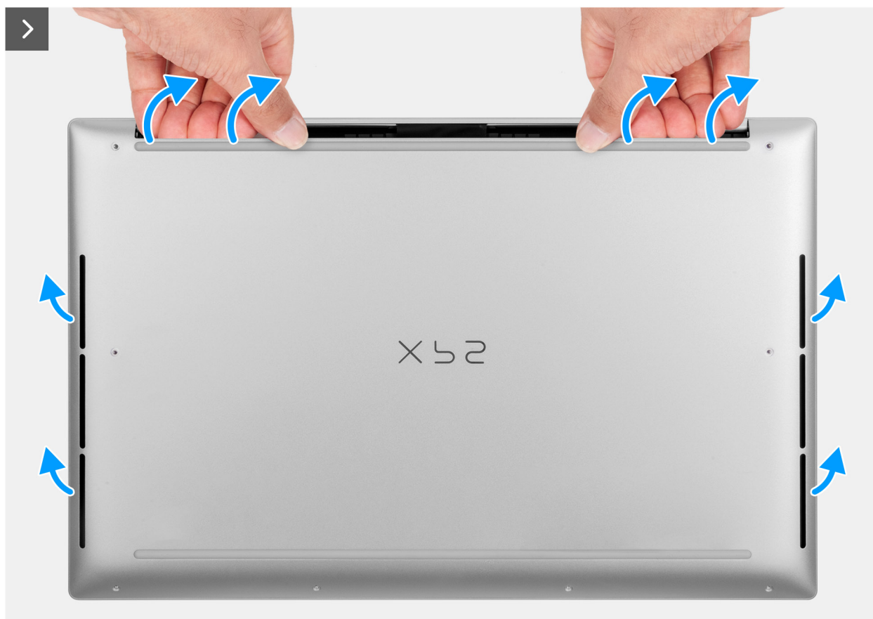
Rysunek 14. Wymontowywanie pokrywy dolnej
