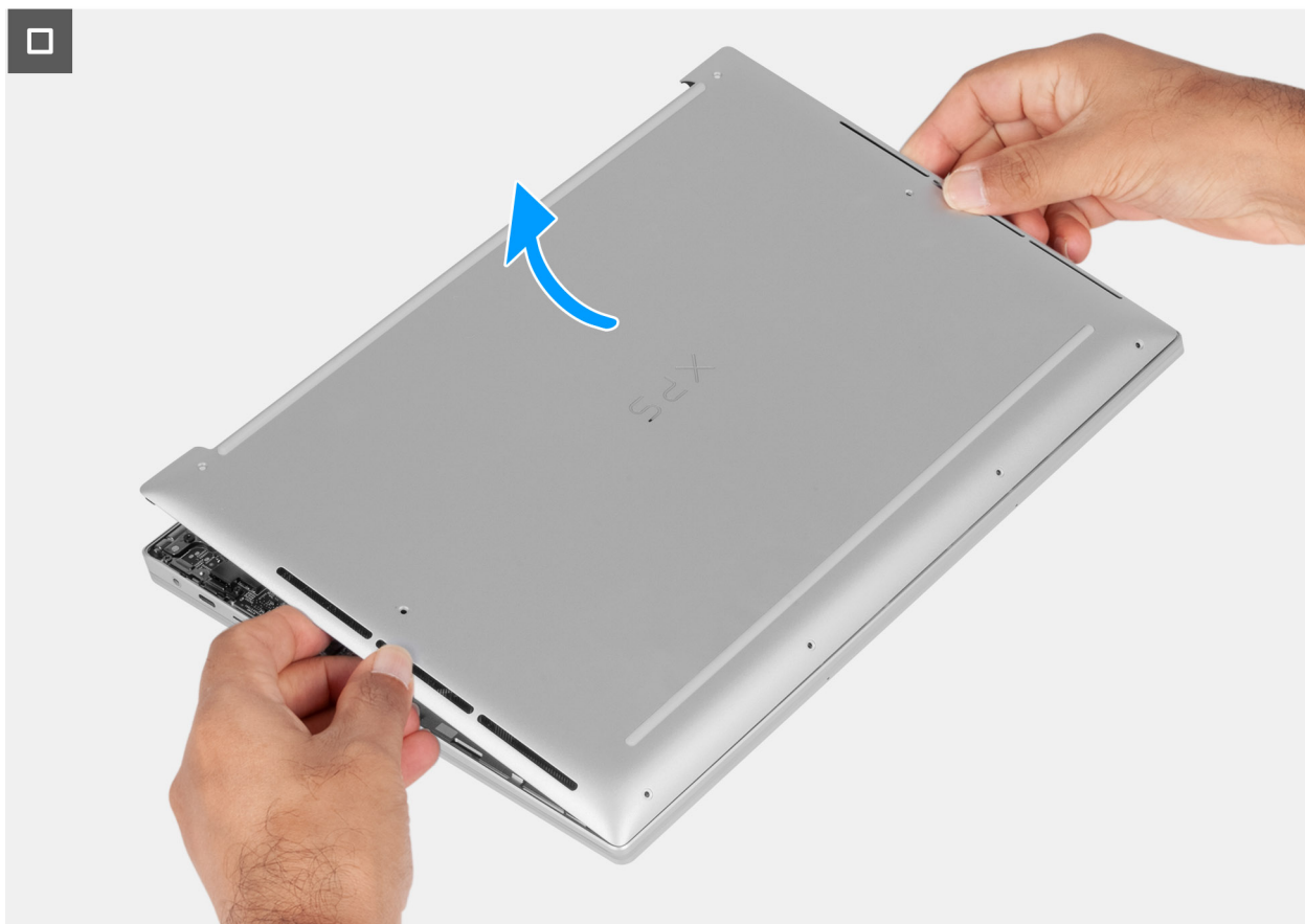
Rysunek 15. Wymontowywanie pokrywy dolnej
