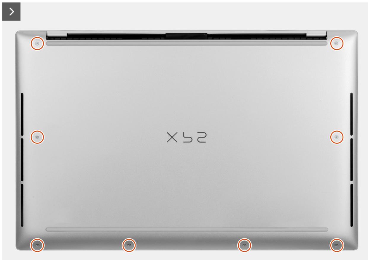
Rysunek 13. Wymontowywanie pokrywy dolnej
