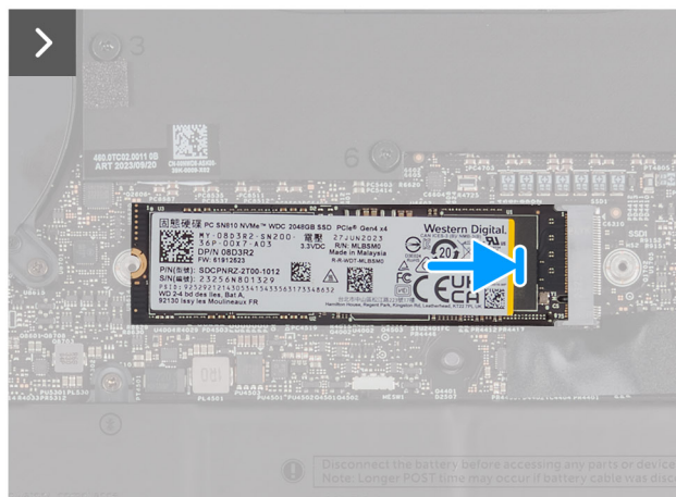
Rysunek 29. Instalowanie dysku SSD M.2 2280
