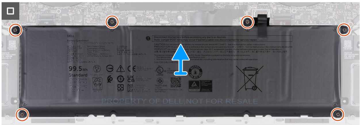
Rysunek 18. Wymontowywanie baterii
