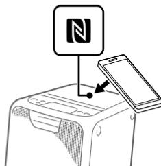
Stellen Sie die Verbindung gemäß den auf dem Smartphone angezeigten Anweisungen her. Wenn die BLUETOOTH-Verbindung hergestellt ist, hört die ☰ (BLUETOOTH)-Anzeige auf zu blinken und leuchtet ständig.
